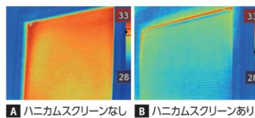
夏季における室内側表面温度の比較。室内温度25℃/室外温度35℃の場合 (財)ペタリーピングにて撮影
