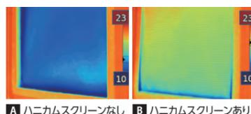
冬季における室内側表面温度の比較。室内温度20℃/室外温度0℃の場合 (財)ペタリーピングにて撮影
